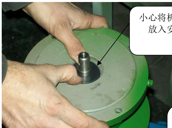
使用非金属工具, 轻拍, 以确保机封定环安装到位
